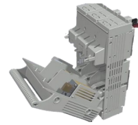
NH-Sicherungen und Sicherungshalter können sowohl als Sicherung als auch als Schutzschalter verwendet werden
